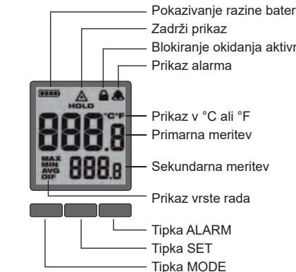
Za biranje poželjne skale temperature aktivirati okidač i tipku SET tri puta pritisnuti. S tipkama iznad strelice birati između °C i °F. 5 sekunda pričekati da namještanje bude pohranjeno i zatim Menue napustiti.
