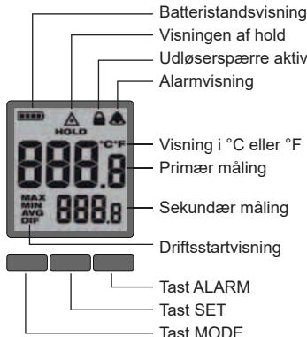
For at vælge den ønskede temperaturskala skal der trykkes på udløseren og tasten SET trykkes 3 gange. Vælg mellem °C og °F med tasterne over pilene. Vent 5 sekunder, indtil indstillingen er gemt, og forlad så menuen.
