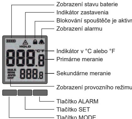
Pro zvolení požadované teplotní stupnice stiskněte spouštěč a třikrát stiskněte tlačítko SET. Pomocí tlačítek zvolte přes šipky °C a °F. Počkejte 5 sekund, až bude uložené nastavení a opusťte menu.
