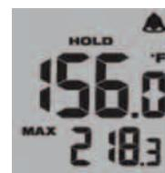
3. Izpustite sprožilec. Do izklopa prikaza bo po 7 sekundah prikazano HOLD.
