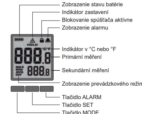
Na zvolenie želanej teplotnej stupnice stlačte spúšťač a tríkrát stlačte tlačidlo SET. Pomocou tlačidiel zvolte cez šípky °C a °F. Počkajte 5 sekúnd, až bude uložené nastavenie a opustite menu.
