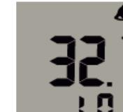
Per selezionare la scala di temperatura desiderata, attivare l'azionatore e premere tre volte il tasto SET. Con i tasti sopra le frecce selezionare °C o °F. Attendere 5 secondi fino a quando l'impostazione non sarà memorizzata, poi uscire dal menu.
