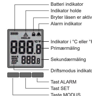
For å velge den ønskede temperaturskalaen trykk bryteren og trykk så tasten SET tre ganger. Velg med tastene via pilene mellom °C og °F. Vent i 5 sekund til innstillingen er lagret og forlat så menyen.
