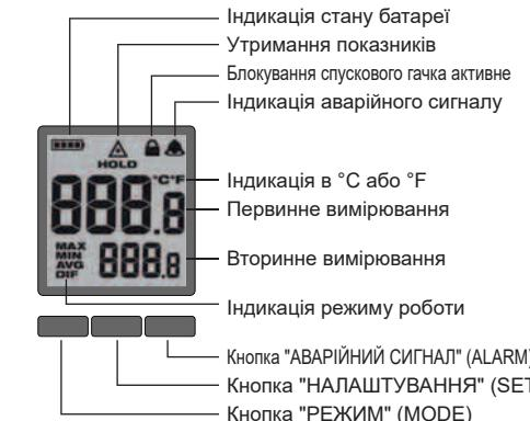
Для вибору необхідної шкали температури натиснути на спусковий гачок і тричі натиснути кнопку "НАЛАШТУВАННЯ" (SET). За допомогою кнопок зі стрілками вибрати шкалу °C або °F. Зачекати 5 секунд до збереження налаштування, потім вийти з меню.
