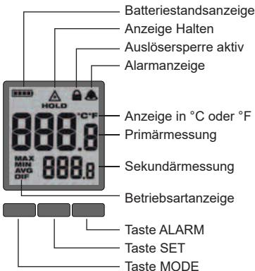
Um die gewünschte Temperaturskala auszuwählen, den Auslöser betätigen und die Taste SET dreimal drücken. Mit den Tasten über den Pfeilen zwischen °C und °F wählen. 5 Sekunden warten, bis die Einstellung gespeichert ist, und dann das Menü verlassen.
