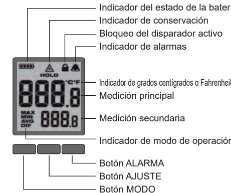
Para seleccionar la escala de temperatura deseada, accionar el disparador y pulsar el botón AJUSTE tres veces. Pulsar los botones situados sobre las fechas para cambiar entre °C y °F. Esperar 5 segundos hasta que se haya guardado el ajuste y, a continuación, salir del menú.
