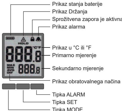
Za izbiro željene temperaturne lestvice uporabite sprožilec in trikrat pritisnite tipko SET. S tipkami nad puščicami izbirate med °C in °F. Počakajte 5 sekund, dokler nastavitev ni shranjena in nato zapustite meni.
