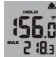
3. Puścić przycisk wyzwalacza. Zanim po około 7 sekundach nastąpi wyłączenie wskaźnika, wyświetlony będzie HOLD.
