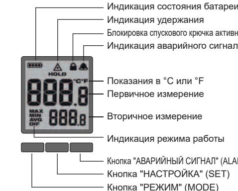
Для выбора необходимой шкалы температуры нажать на спусковой крючок и трижды нажать кнопку "НАСТРОЙКА" (SET). С помощью кнопок со стрелками выбрать шкалу °C или °F. Подождать 5 секунд до сохранения настройки, затем выйти из меню.
