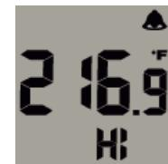
Для налаштування діапазону значень для спрацьовування аварійного сигналу натиснути на спусковий гачок і натиснути кнопку "НАЛАШТУВАННЯ" (SET). Повторити процес для того, щоб змінити налаштування HI і LO.
