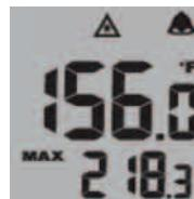
ΥΠΟΔΕΙΞΗ: Το αντικείμενο θα έπρεπε να είναι μεγαλύτερο απ' ό, τι το προς μέτρηση σημείο, επειδή διαφορετικά μπορεί να προκύψουν ανακρίβειες μέτρησης. Βλέπε το σημείο «Απόσταση από το σημείο μέτρησης» για λεπτομερείς πληροφορίες περί του μεγέθους του αντικειμένου.
