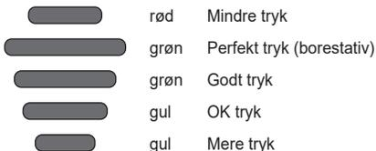
Indikatoren for ydeevne giver tilbagemelding om trykket under boringen. Når der udøves tryk på boremaskinen, vil indikatorene begynde at lyse i takt med det tryk, der udøves. Øg eller reducer trykket, indtil den grønne LED lyser, hvilket indikerer et perfekt tryk.
