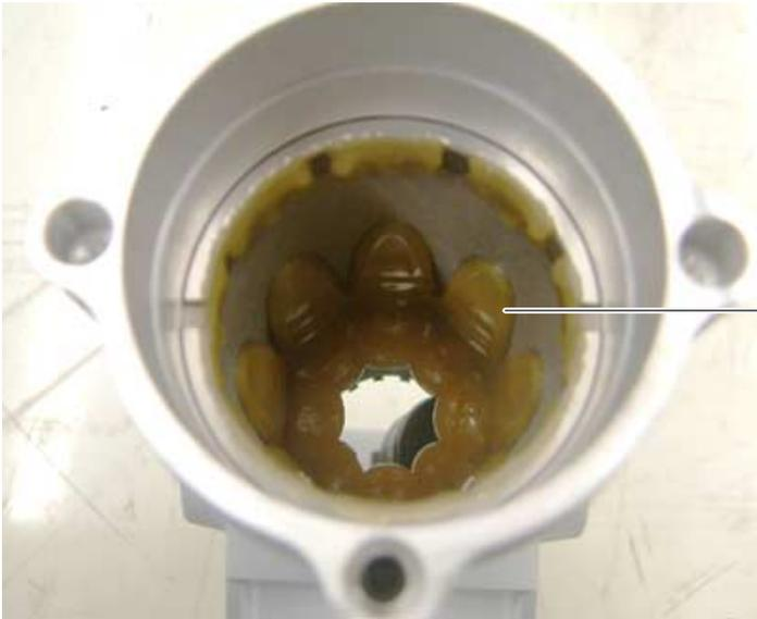
ca. 48 g Fett Darina (**A**) ins Spindelgehäuse (Getriebekasten von vorn) einbringen
